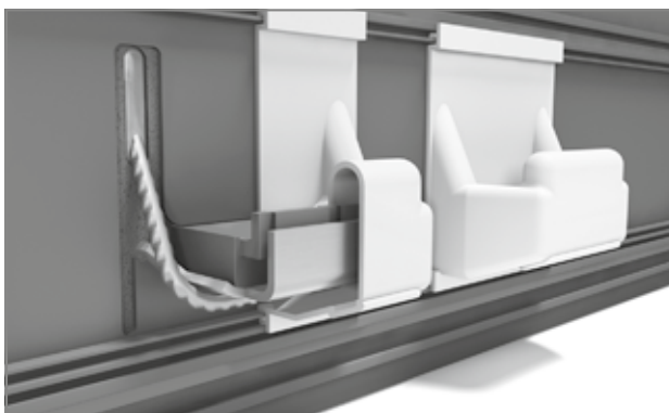
Schöck Tronsole® Typ T in der 3D-Ansicht: Das Elastomerlager Elodur®, der Auflagerwinkel und der Querkraftbügel sind hier zur Darstellung freigelegt.
